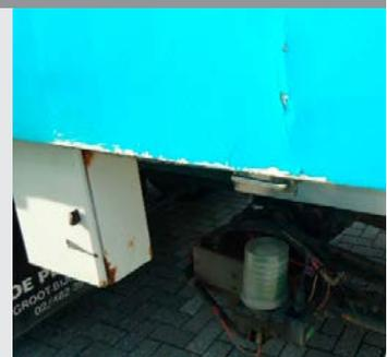
Daños leves en las esquinas de la base del contenedor que no dejan ver la capa de imprimación.
