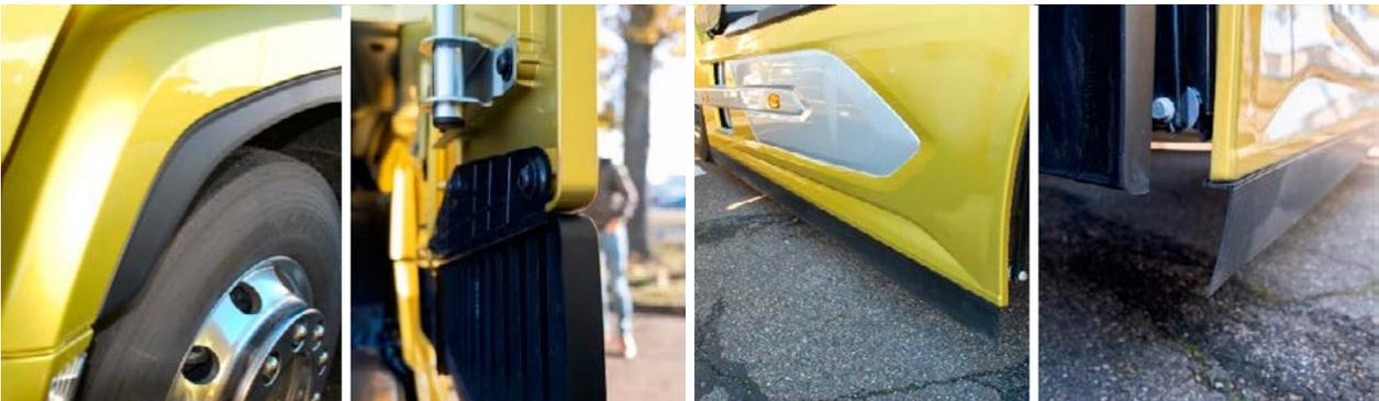
Ambas varillas de basculación deben estar presentes y almacenadas detrás de los paneles de esquina de la parte delantera de la cabina.
