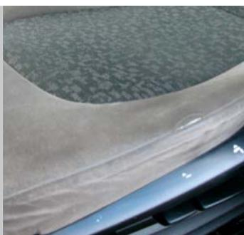
Grietas y cortes en las cubiertas de los asientos como resultado de un uso incorrecto o de un cuidado inadecuado.
