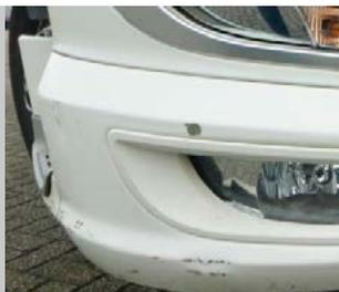
Grietas y orificios en la unidad de luces combinadas.
