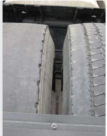
Desgaste normal de la carcasa del neumático.
