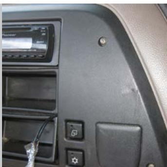
Marcas o arañazos profundos en el panel de instrumentos. Orificios perforados en el salpicadero. Faltan placas de revestimiento.
