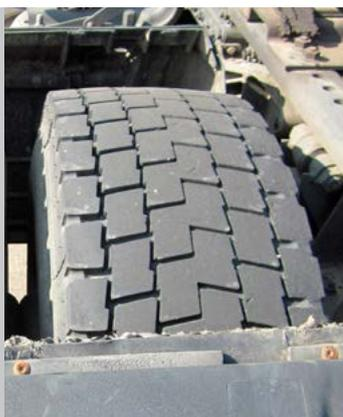
Desgaste irregular, grietas o daños en la banda de rodadura o en los laterales.
