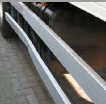
Protecciones laterales dobladas o alteradas, incluidos los soportes.
