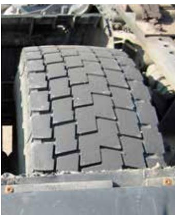
Desgaste normal en la carcasa del neumático y perforaciones en el perfil.
