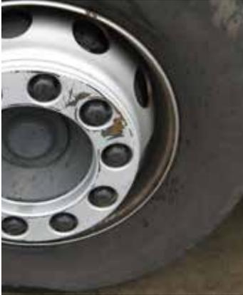
Daños en las llantas debidos al uso; desgaste leve en los laterales provocado por roces contra el bordillo.
