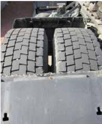
Un desgaste normal de neumáticos con un mínimo de banda de rodadura de 8 mm en todas las ruedas.
