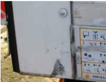
Daños leves en las esquinas de la base de la carrocería, en las que no llegue a verse la imprima-ción.
