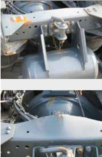
Deformación del chasis y/o daños a consecuencia de un accidente o cualquier otro arreglo.
