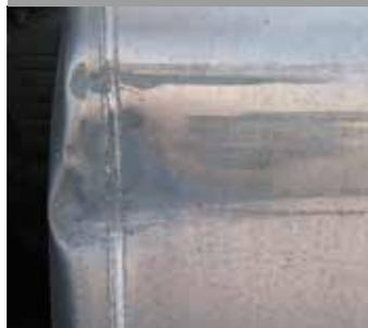
Abolladuras en el depósito de combustible y deformación del depósito de combustible.
