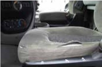
Grietas y cortes en las fundas del asiento a consecuencia de un mal uso o de cuidados inadecuados.
