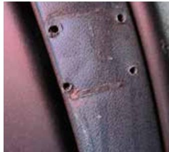
Arañazos profundos o marcas en el panel de instrumentos. Perforaciones en el panel de instrumentos. Falta la placa de protección.
