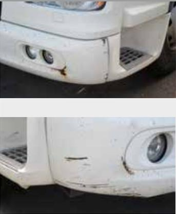
Parachoques abollados, doblados o deformados.
