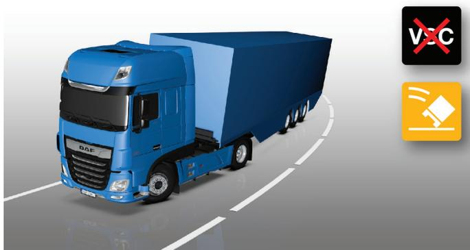
En caso de escasa deriva, la parte delantera del vehículo se desliza hacia el exterior de la curva y, si no se corrige, acaba saliendo de la carretera. El sistema VSC aplicaría los frenos en las ruedas que giran por el interior de la curva para devolver a las ruedas tractoras a la ruta deseada.
